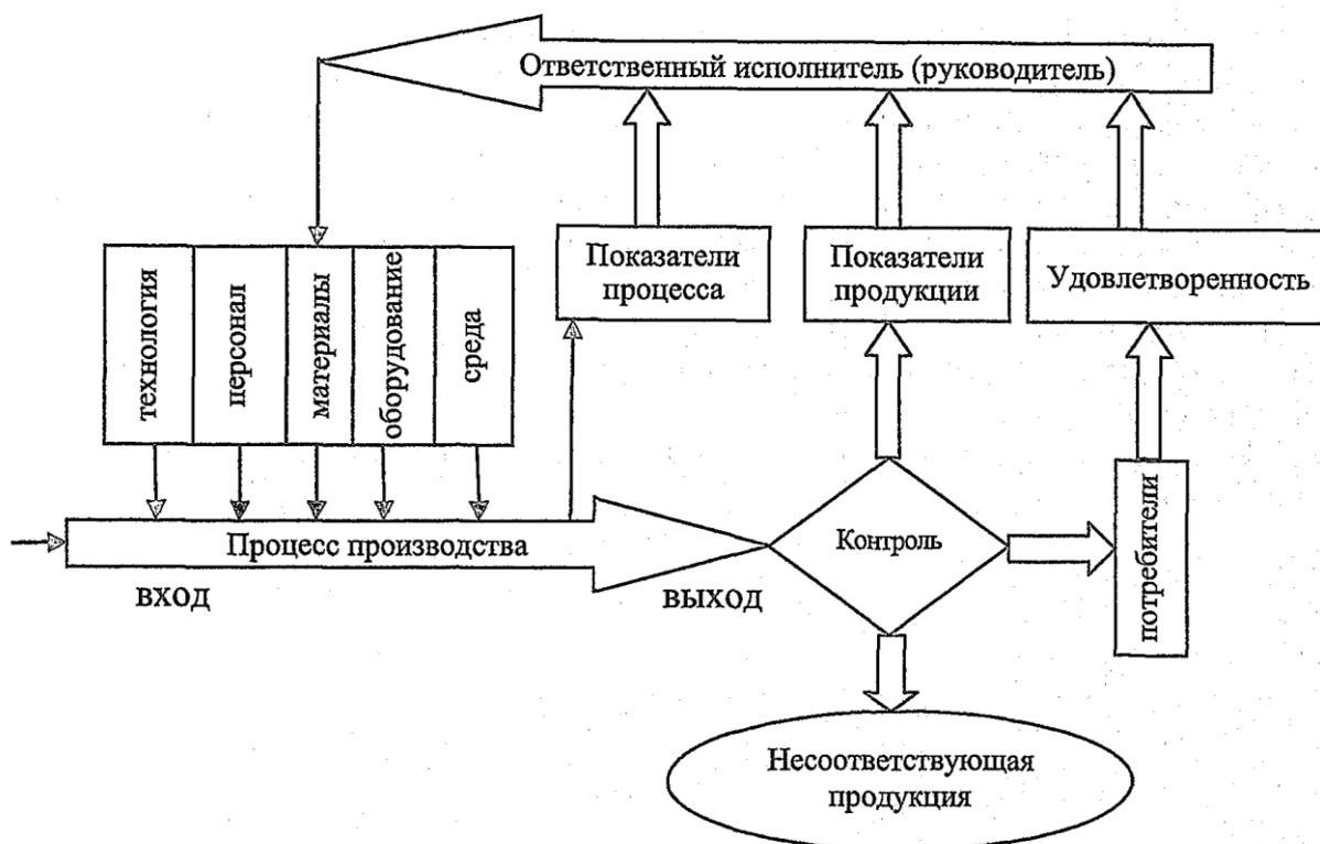
Рис. 1. Схема управления процессом
